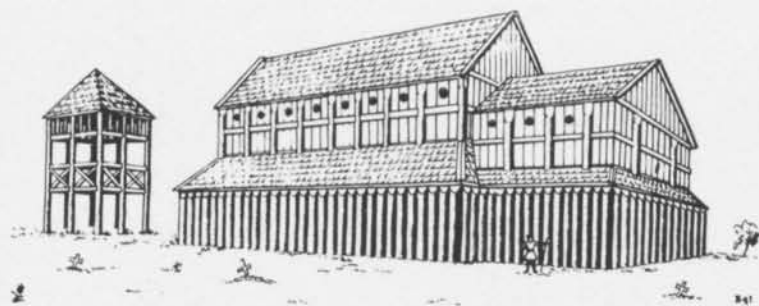
Fig. 1. S:t Drotten, Lund. Ragnar Blomqvists forslag fra 1961 til rekonstruksjon av den jordgravne "palisade"-bygde stavkirken fra 1050-60. (Etter Mårtensson & Wahlöö 1970.) Et lignende, men noe forskjellig forslag fra hans hånd er gjengitt i Mårtensson 1980. - Proposed reconstruction by Ragnar Blomqvist of the stave church S. Drotten at Lund, dated 1050-60.
